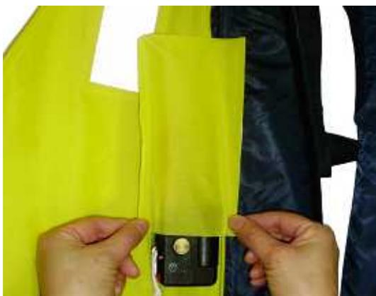
スプール及びボンベ・安全ピンの再セットを確認してから、膨脹装置に保護カバーを被せます。(保護カバー無い機種もあります。)
