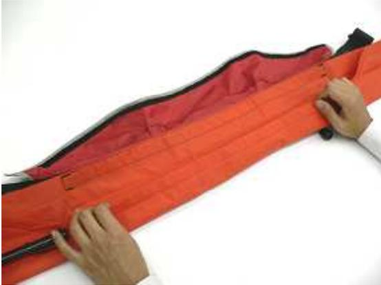
スプール及びボンベ・安全ピンの再セットを確認してから、外装布を下にして置き、気室を横半分に折ります。
